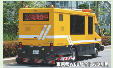
東京都ウェブサイトより引用 道路下の状態を調査・点検する「空洞探査車」
